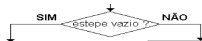
Se a resposta for sim as setas indicam um caminho a ser tomado com um determinado tipo de ação (chamar um borracheiro) se a resposta for não as setas indicam outro caminho (para que se faça várias ações até trocar o pneu). Observe abaixo:
